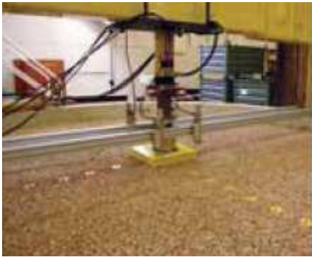
Ensayos de capacidad portante realizados en el BRE confirman que las geomallas triaxiales aumentan la distribución de cargas
